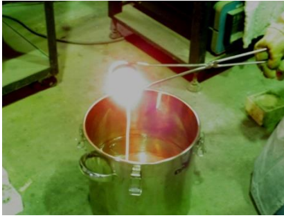
写真1 試製スラグの試製状況（水冷）
