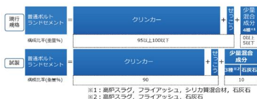
図2 試製した10%化Nの構成
