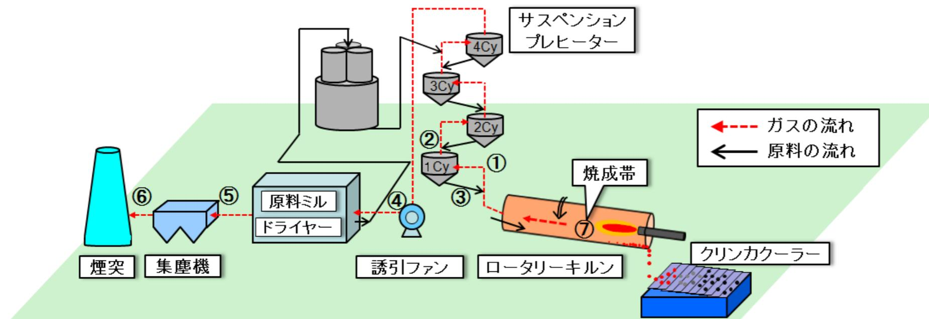
図 セメント製造工程の概略図
